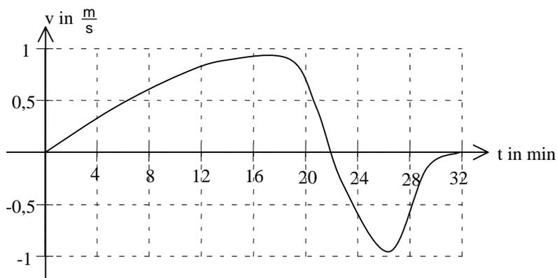
Das Diagramm zeigt die Vertikalgeschwindigkeit  $v$  (positiv bei Aufwärtsbewegung) eines Heißluftballons in Abhängigkeit von der Fahrzeit  $t$ . Der Ballon startet zum Zeitpunkt  $t = 0$  in 300 m Höhe über NN.
